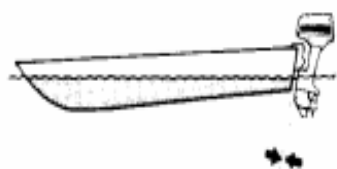
Za duży kąt przyglębienia (tendencja do nurkowania)
